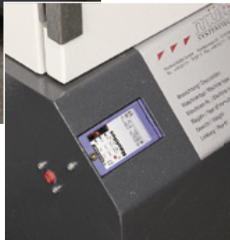
Der Pressdruck kann an der kleinen roten Schraube seitlich am Gehäuse eingestellt werden. Ein Zeiger an der Druckverstellung zeigt den vorgewählten Druck.
