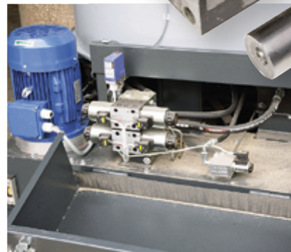
Der Motor für den Hydraulikantrieb der MPP 60 benötigt eine Anlaufleistung von 5,5 kW, im Dauerbetrieb hat er eine Leistungsaufnahme von 4 kW.
