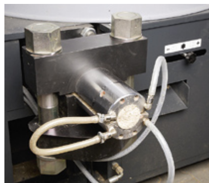
Wenn im Dauerbetrieb kontinuierlich Brikketts hergestellt werden sollen, muss die Zange gekühlt werden.
