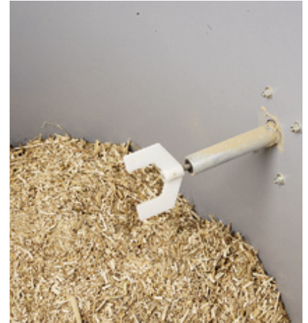
Der Paddelsensor dient der Füllstandsüberwachung im Vorratsbehälter.
