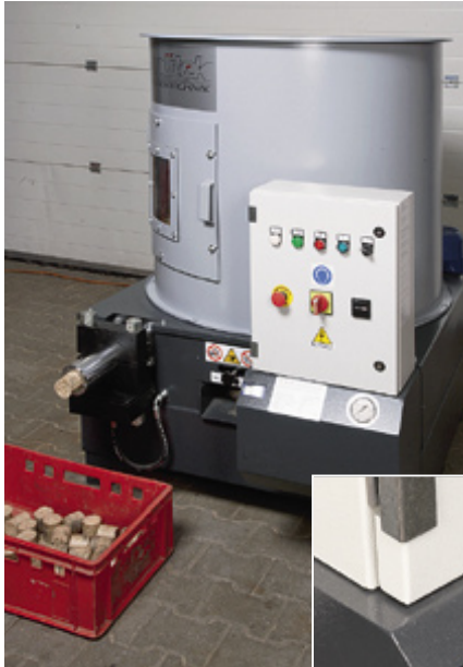
Der Vorratsbehälter bei der MPP 60 (und auch bei der MPP 110) fasst einen Kubikmeter.
