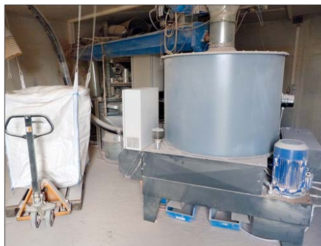
Mit den abgesaugten Spänen und Stäuben werden Produktion und Verwaltung bei Renner geheizt. Bei weniger Wärmebedarf werden sie komprimiert. Die Firma Müttek, die an der Absauganlage bei Renner beteiligt war und die Brikettpresse geliefert hat, sorgt für die Vermarktung der Briketts
