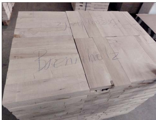
Im Durchschnitt 40 % des gekauften Weißbuchenholzes schaffen es nicht durch die Eingangskontrolle (Auslese), bei der die Eignung für die unterschiedlichen Teile, die in Gärtringen hergestellt werden, geprüft wird. Es fällt in die sechste Kategorie: Brennholz
