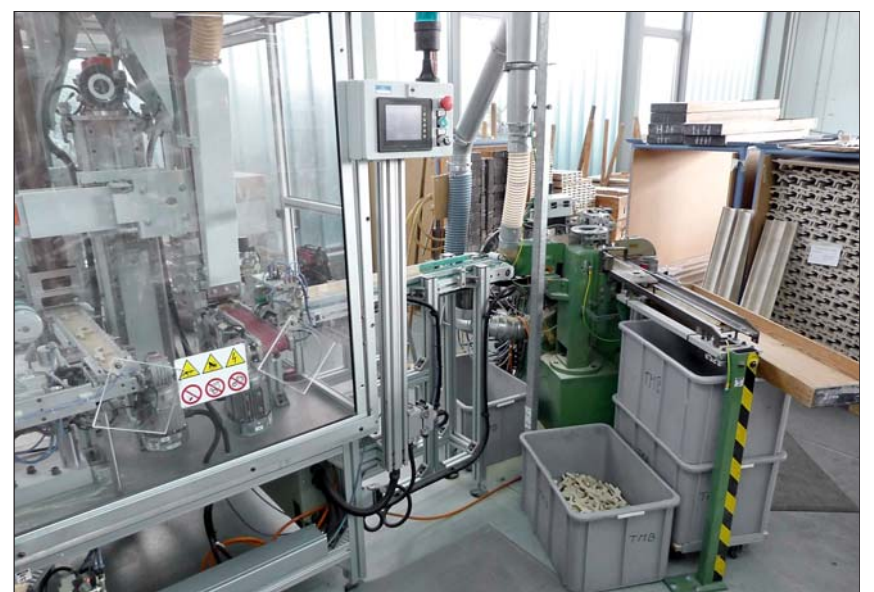
Aus Profilelisten (rechts) werden die Rohlinge für die einzelnen Bauteile geschnitten und dann weiter bearbeitet. Die Produktion bei Renner beinhaltet trotz modernster Maschinen auch noch viel Handarbeit
